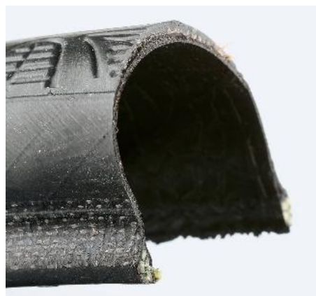
Testsieger Conti „Grand Prix 4000 RS“: vollwertiger, sehr leichter Drahtreifen mit Kevlarkernen (faltbar), wirksamem Pannenschutz und herausragenden Fahreigenschaften. Die Lauffläche ist dünn, hält aber bis 3.500 Kilometer. Der Reifen wird mit Schlauch montiert. Die Reifenkerne stützen sich dann am Horn der Felge ab
