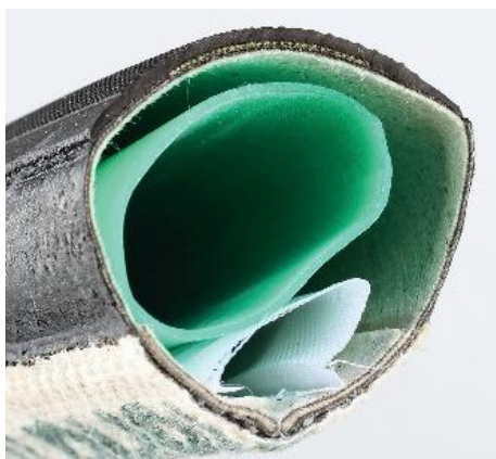
Zeitfahrsspezialist Vittoria „Crono Evo CS 22“: Die Karkasse des Schlauchreifens ist unten vernäht und umschließt den zarten Latex-Schlauch. Der Rollwiderstand ist niedrig, aber deutlich höher als bei den besten Drahtreifen. Der Reifen wird mit Schlauchreifenfelgen verklebt
